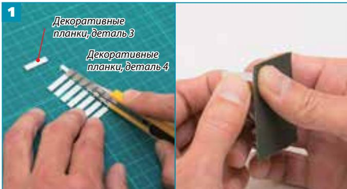
1 Отделите детали 3 и 4, проведя по разрезам несколько раз канцелярским ножом (см. слева). Затем обработайте срезы наждачной бумагой (см. справа)
