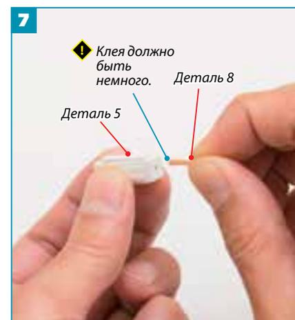
**7** Так же, как в шаге 6, нанесите небольшое количество клея на деталь 8 и вставьте ее в деталь 5.
