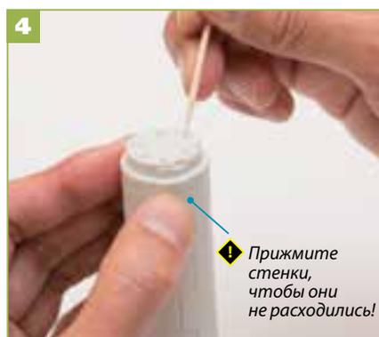
**4** Нанесите в каждое отверстие крепежной пластины немного клея, закрепляя таким образом стенки изразцовой печи.
